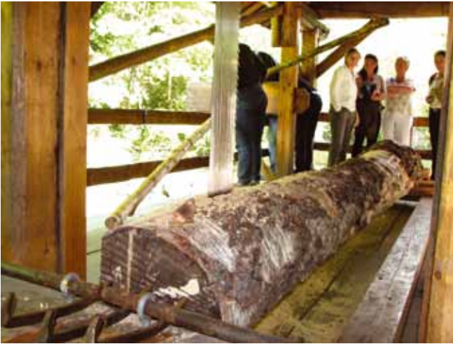
Oppgangssaga skjærer en tømmerstokk i god fart.
