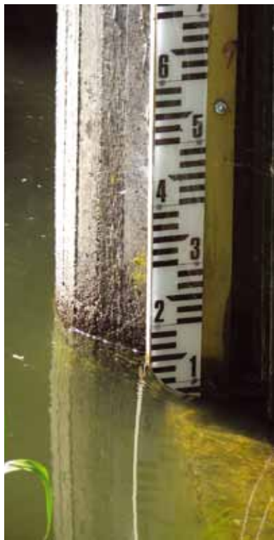
Målepinnen ved utløpet.
