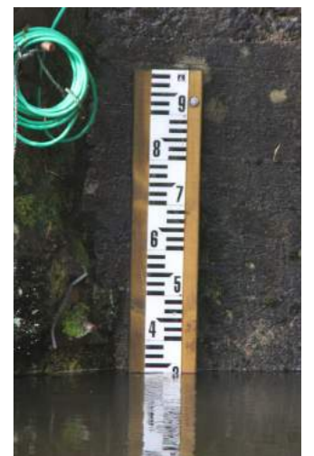
Målestaven viser "32" om morgenen 7. september, det er "all-time-high" vannstand som er avlest. Tallet står for cm over "normal" vannstand. Hevertmekanismen gikk for fullt, men klarte ikke å få vannet ut like fort som det rant inn.
