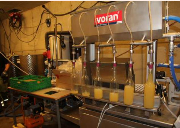
Tappemaskinen fyller opp seks flasker samtidig.
