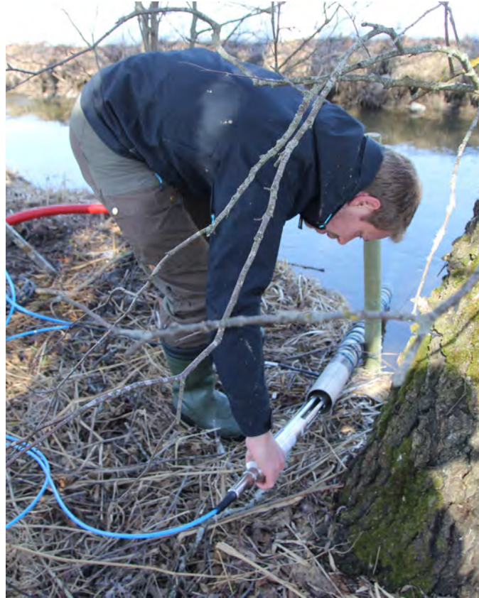
Prøvetakingsinstrumentet skyves inn i et rør og senkes ned i Bølerbekken. Fra instrumentene overføres resultatene via kabel til en stasjon som periodisk videregirer til NIBIO for analyse. Foto: 12.04.2018.
